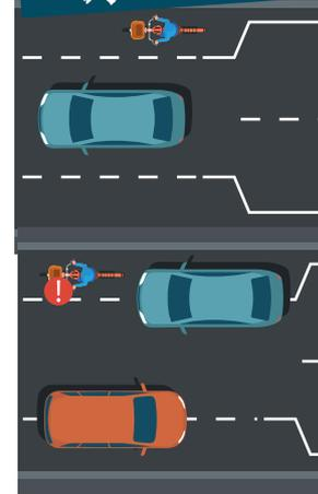
Une chaussée pour les circulations douces (chaucidou) permet de concentrer la circulation des véhicules sur le centre de la route afin de créer un espace sécurisé et visible pour les vélos. C'est cette chaussée que l'on peut retrouver Boulevard de Strasbourg.
