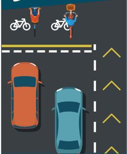
Un SAS vélo est un espace aménagé spécialement pour les cyclistes dans un carrefour à feux rouges. Il se situe entre le feu tricolore et la ligne pointillée devant laquelle doivent s'arrêter les voitures. Il s'agit d'un aménagement réservé aux vélos.
